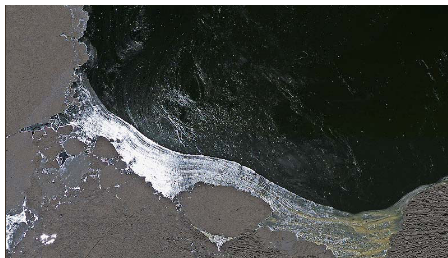
Das graubraune Bindemittel soll das schimmernde Öl oberhalb der Sperre aufhalten und kann anschliessend abgesaugt werden.
